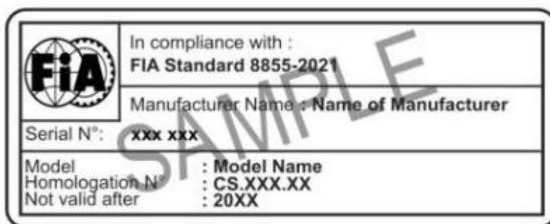
Figure 3. Modèle d'étiquette à apposer sur chaque support de siège
