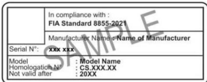
Figure 2. Modèle d'étiquette à apposer sur le siège
